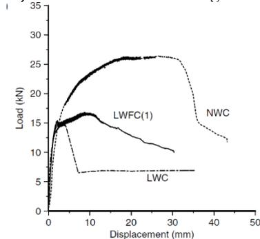
c) Tensile load-dis. Curves (Shear connector Ø10mm).
