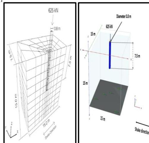
a- Analysis using FLAC<sup>3D</sup> b- Analysis using PLAXIS3D
