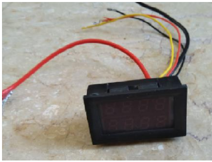
Figure (21): Mini Digital Voltage – Ampere meter
